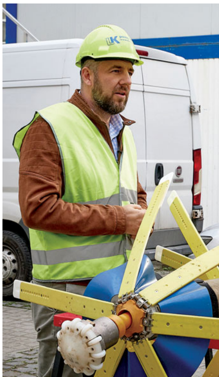
▲ Ultrazvukové měření stěn potrubí se vodohospodářům osvědčilo.
